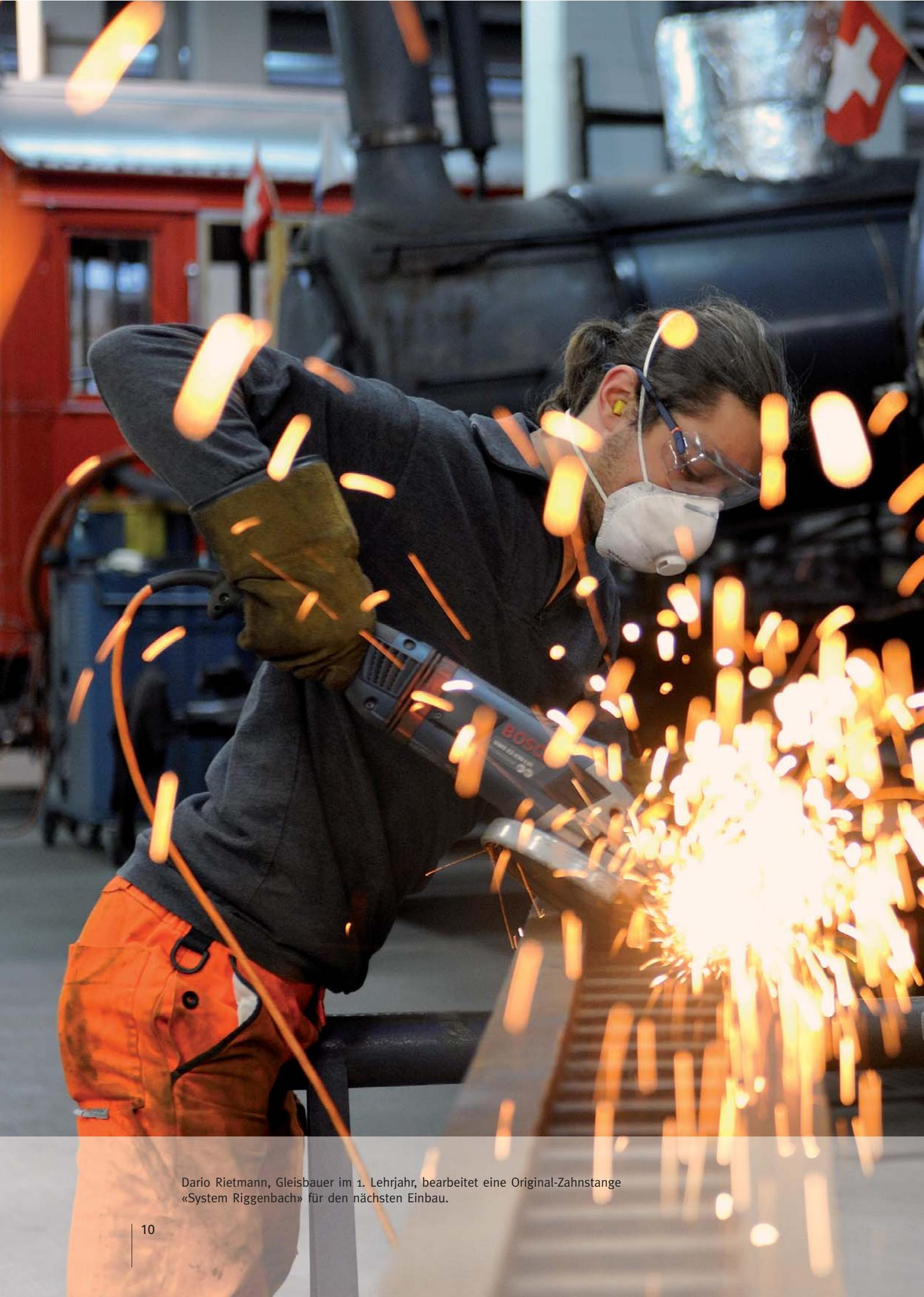
Dario Rietmann, Gleisbauer im 1. Lehrjahr, bearbeitet eine Original-Zahnstange «System Riggenbach» für den nächsten Einbau.
